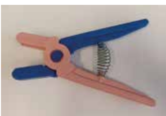
Zange zum Einziehen von Datamars Tagfaster-Ohrmarken für Schafe und Ziegen
