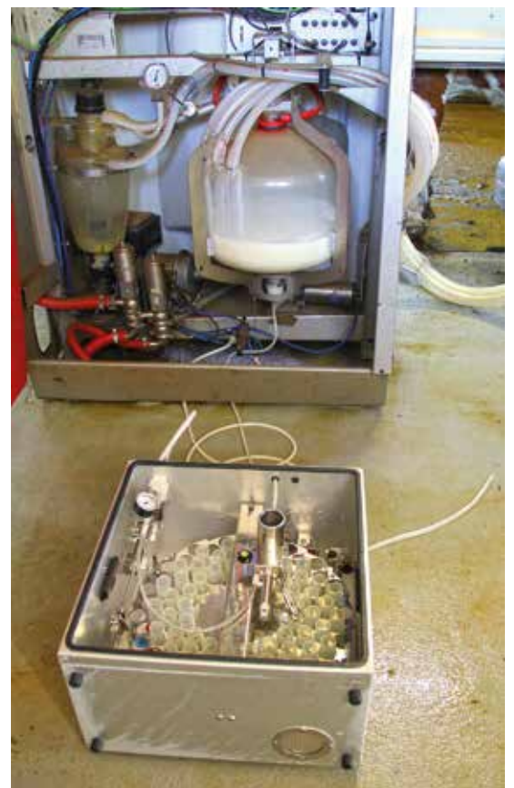
Probenahmegerät Ori-Collector bei der Arbeit
