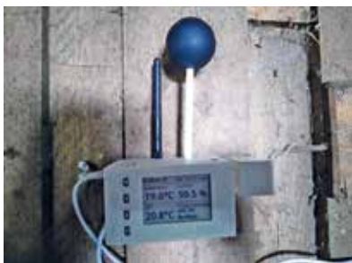
Abb. 2: Interessante Daten lieferten die Klimadatenlogger, die in 16 Milchviehbetrieben installiert wurden.
