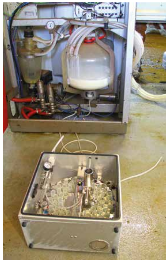
Probenahmegerät Ori-Collector bei der Arbeit
