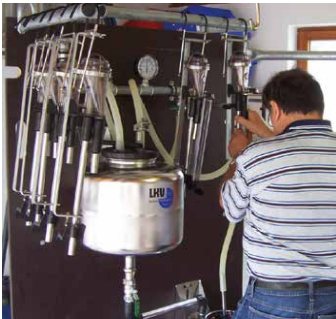
Überprüfung mobiler Milchmessgeräte in Aulendorf
