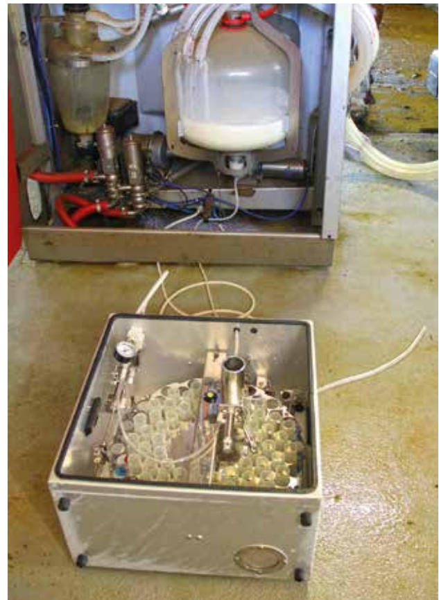
Probenahmegerät Ori-Collector bei der Arbeit
