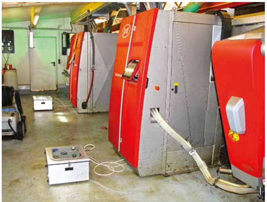
Probenahmegerät Ori-Collector bei der Arbeit
