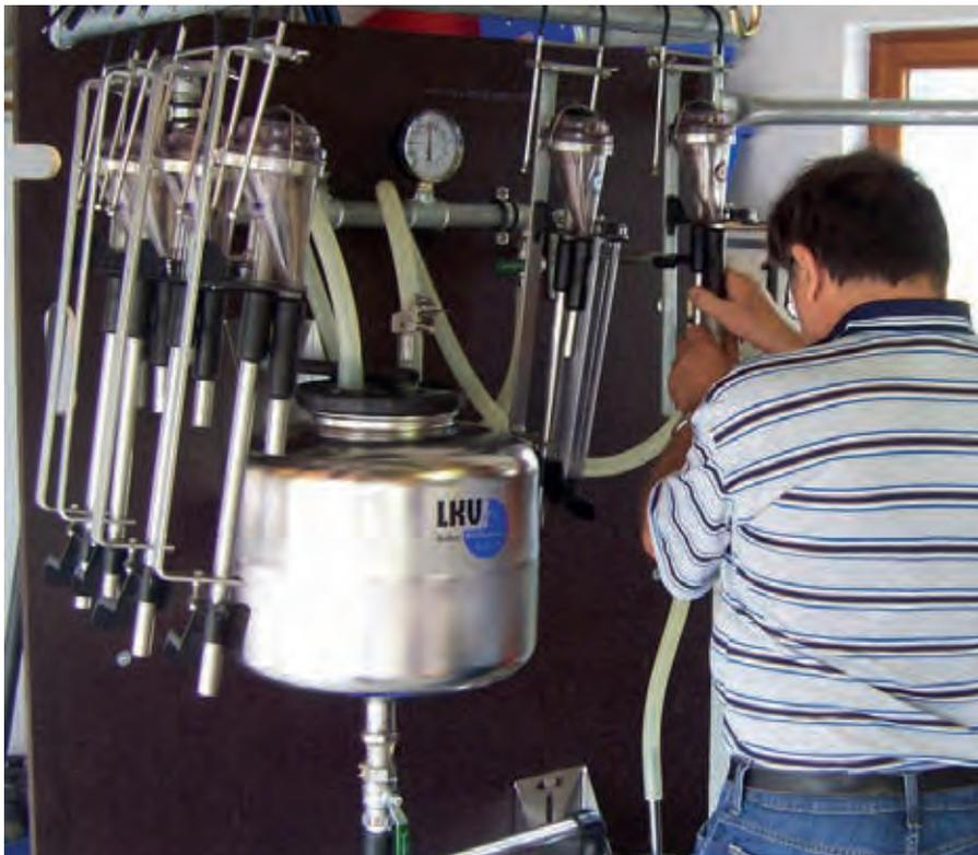
Überprüfung mobiler Milchmengenmessgeräte in Aulendorf
