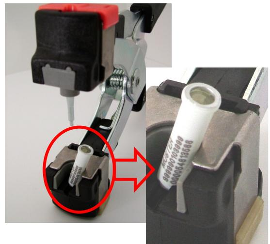
*Um Infektionen wirksam vorzubeugen, darf der Dorn der Ohrmarke beim Einsetzen in die Zange nicht berührt werden! So gelangt kein Schmutz von den Händen in die frische Ohrwunde. Ziehen Sie darum das Dornenteil bitte an der Lasche auf den Zangendorn.*
