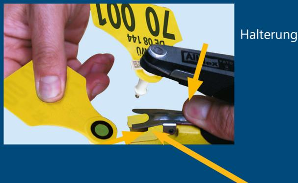
Für den Einzug der zweiten Ohrmarke kann ebenfalls die gelb-schwarze Zange genutzt werden. Setzen Sie hierzu den mitgelieferten Dorn ein. Für den Einzug einer elektronischer Ohrmarke muss zusätzlich der gelbe Adapter aus der Zange entfernt werden.
