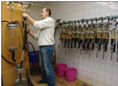
Justierung der portablen Milchmengenmessgeräte in der Justierstelle Aulendorf
